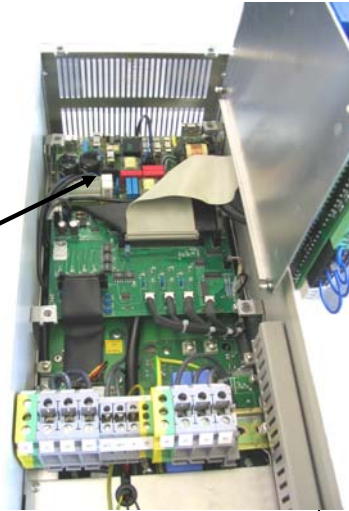
Рис. 9: Компактное устройство шириной 165 мм, штекер внешнего питания БУ
