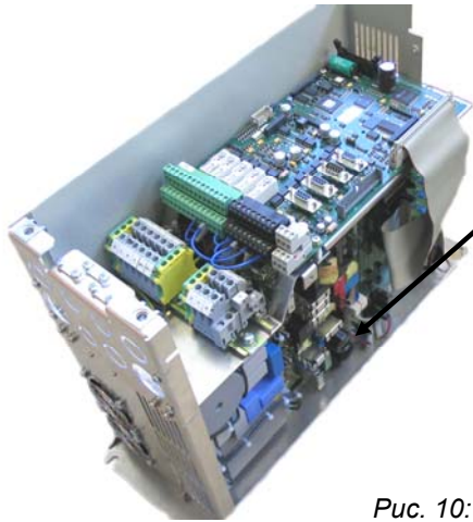
Рис. 9: Компактное устройство шириной 165 мм, штекер внешнего питания БУ
