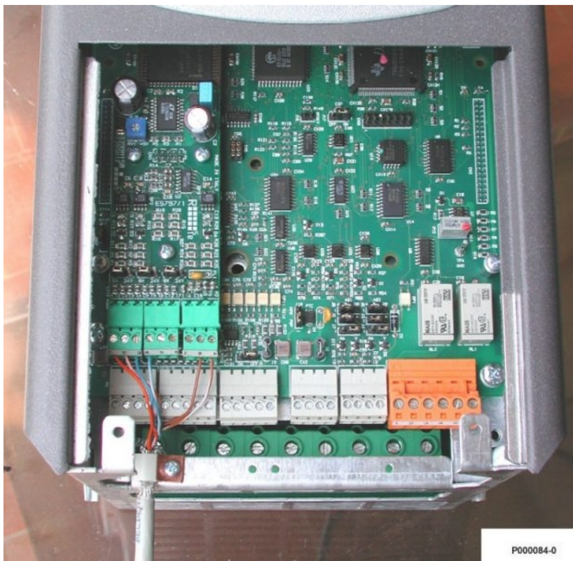
Рис. 85: Подключение кабеля датчика.
