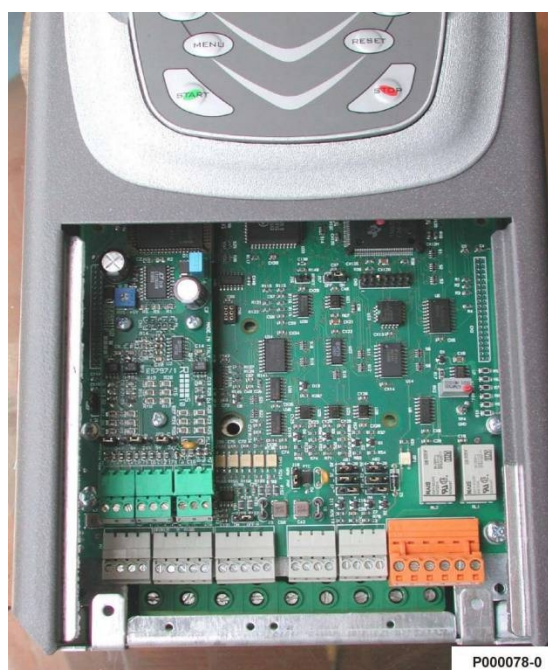
Рис. 79: Плата датчика, установленная в преобразователь.
