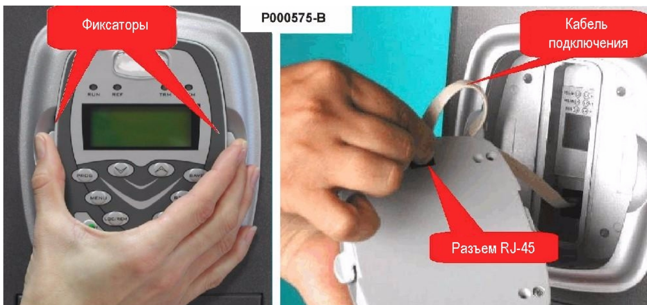
Рис. 69: Снятие пульта управления.
